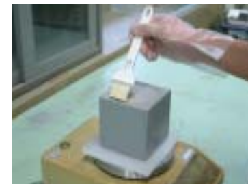
写真 - 1 含浸工程実施状況
